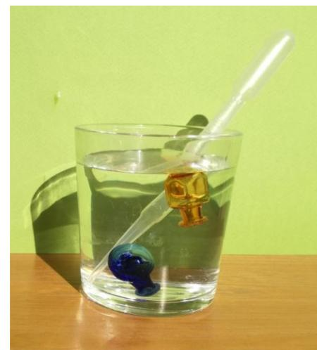
Водолазы заполняются с помощью пипетки Пастера, их плавучесть контролируется в отдельном сосуде
