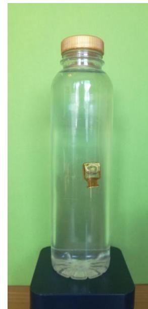
У точно отрегулированного водолаза вместе с двумя устойчивыми положениями равновесия, одно вверху и одно внизу, существует еще одно – промежуточное, неустойчивое
