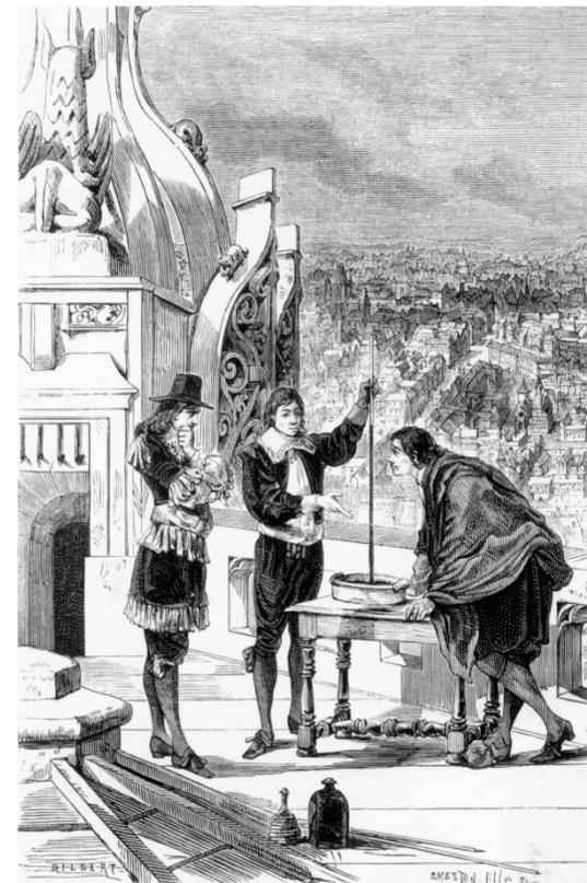
Паскаль в Париже на вершине 52-метровой башни Сен-Жак воспроизводит эксперимент Торричелли, он объясняет, что, из-за уменьшения давления воздуха при подъеме, высота ртути в трубке, наблюдаемая на вершине башни, на 4 мм ниже, чем у ее основания, 1648 г.
