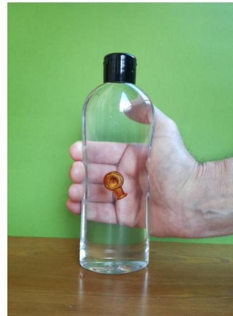
Водолаз обратного действия в овальной бутылке, в свободном состоянии он покоится на дне, если нажать на ребра бутылки, всплывает ⇒
