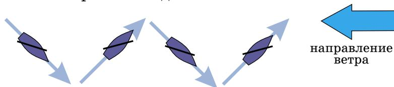
Сила давления ветра раскладывается на продольную и поперечную (относительно корпуса) составляющие. И пока угол паруса относительно ветра таков, что продольная составляющая направлена к носу судна, оно будет двигаться вперёд. (Поперечная составляющая пытается сдвинуть судно «вбок» и компенсируется килевой системой.) Минимальный угол между направлением ветра и курсом обычно составляет  $45^\circ$ . Лишь некоторые спортивные суда могут плыть под более острым углом — до  $20^\circ$ .
