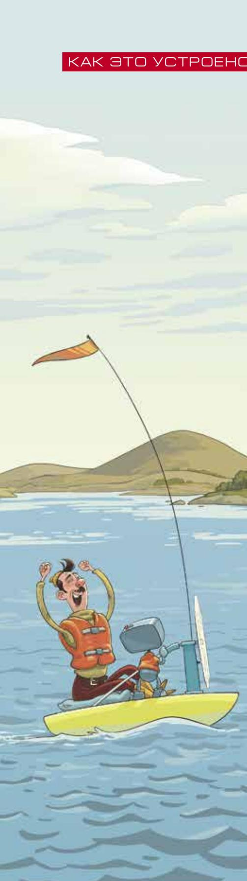
Устроен двигатель очень просто: это длинный стержень (вал), на одном конце которого закреплён ветроприёмный пропеллер, а на другом – гребной винт. Вал установлен под наклоном, чтобы гребной винт был полностью погружён в воду, а пропеллер располагался над водой. Набегающий ветер вращает пропеллер, через ось это вращение передаётся на гребной винт, который толкает судно.
