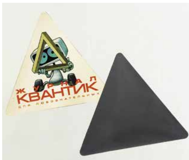
Виниловый магнит и вид на него через плёнку, визуализирующую магнитные поля
